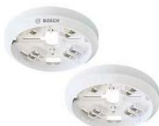
Für automatische Brandmelder der Serie 420 LSN improved | für a.P. und u.P. Kabelzuführung | Anschlüsse Spannungsversorgung (0 V, +V), LSN (a1/ a2, b1, b2), C-Punkt, Abschirmung, Relais (NO, C, NC) | Gehäuse: • Abmessungen (ØxH) 120 x 22,7mm • Material ABS (Novodur) • Farbe RAL 9010 | Gewicht 72g
